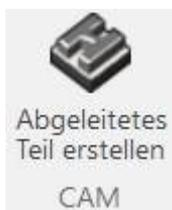
Von allen markierten Dokumenten, die ein CAD-Part (Solidworks oder Inventor) enthalten, wird ein abgeleitetes Teil erstellt.
