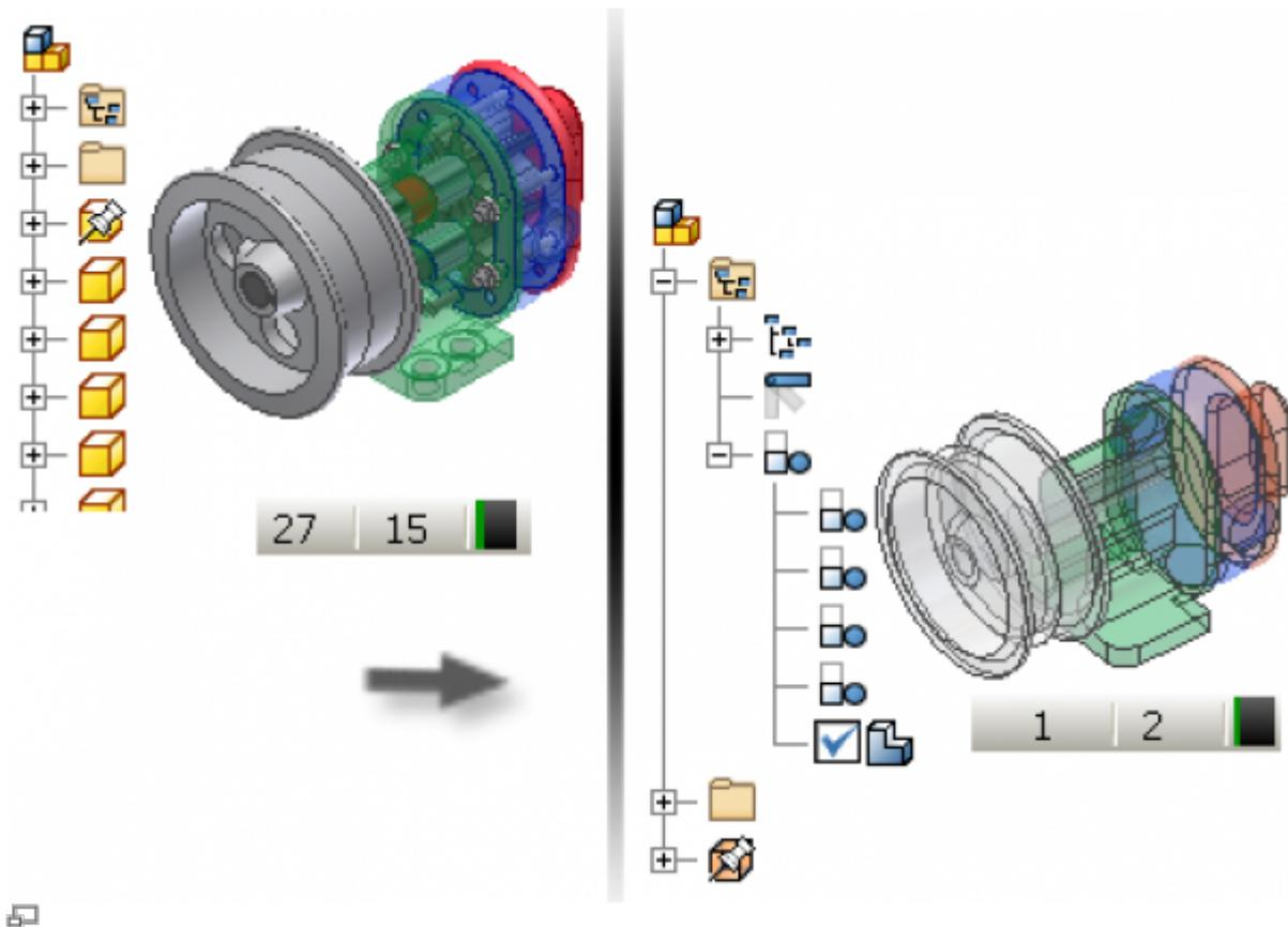
Baugruppenersatzobjekte sind eine Art von Detailgenauigkeitsdarstellung. Ein Ersatzobjekt verwendet eine einzelne Bauteildatei für die Darstellung einer gesamten Baugruppe.
