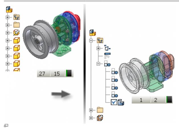
Baugruppenersatzobjekte sind eine Art von Detailgenauigkeitsdarstellung. Ein Ersatzobjekt verwendet eine einzelne Bauteildatei für die Darstellung einer gesamten Baugruppe.
