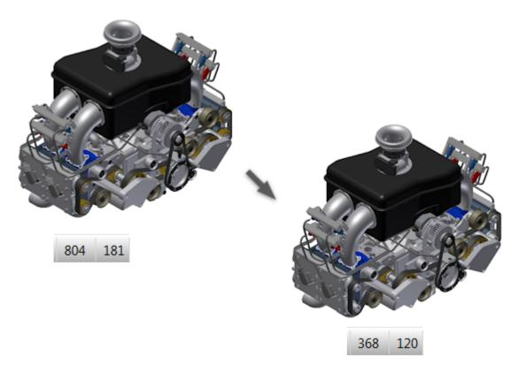
Mithilfe von Detailgenauigkeitsdarstellungen verwalten Sie, welche Komponenten in den Speicher geladen werden. Sie verwalten außerdem die Speichernutzung der Software. Detailgenauigkeitsdarstellungen unterdrücken Komponenten (Bauteile oder Unterbaugruppen) in einer Baugruppe. Die unterdrückten Komponenten werden nicht in den Speicher geladen.
