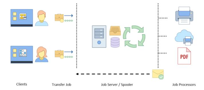
Um einen Jobserver einzurichten wird der Spooler-Mechanismus genutzt. Jobs können nur abgearbeitet werden wenn die entsprechende Konfiguration erstellt wurde und die entsprechenden Module vorhanden sind. Es wird eine Transferdatei genutzt um die Jobs an den Jobserver zu übergeben. Diese Datei hat die Endung \*.jsjob. Wird ein Jobserver verwendet werden die Jobs auf dem Server ausgeführt.
